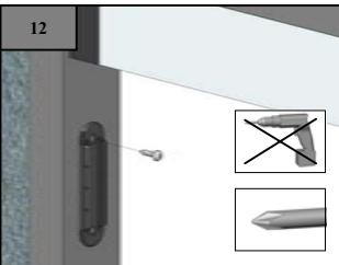
Enlevez les feuillets des bandes. Glissez la latte de fixation contre le chambranle afin de déterminer l'endroit des fixations.
