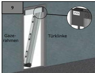
Setzen Sie die untere Schiene genau senkrecht zur oberen Schiene auf die Türschwelle. Entfernen die Schutzfolie vom Klebestreifen. Gut andrücken.
