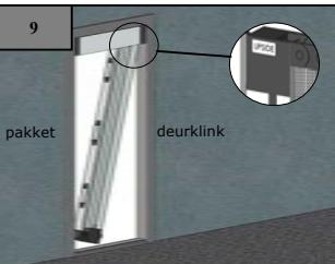
Plaats de onderrail recht onder de bovenrail op de dorpel. Verwijder de afdeklaag van de strip. Druk goed aan.
