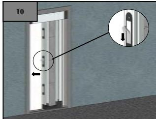
Verwijder de afdeklaag van de strips. Schuif de bevestigingszijde tegen het kozijn om de plaats voor de bevestigingsclips te bepalen.
