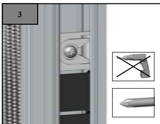
Draai de schroef met het achterliggende witte plaatje enkele slagen los.
