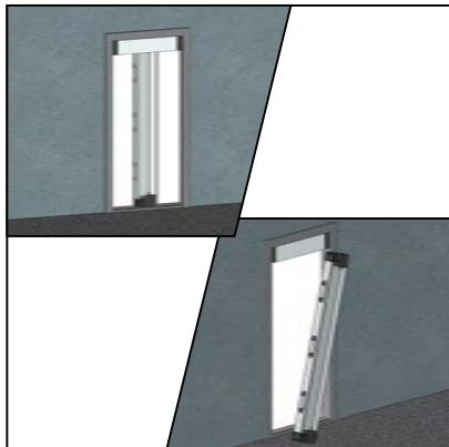
Öffnen Sie die Fliegengittertür und ziehen Sie die Befestigungsleiste mit etwas Kraftaufwand von den Halterungen. Sie können die Fliegengittertür ohne Schwierigkeiten herausnehmen, indem Sie an dem Gazerahmen etwas schräg ziehen.
