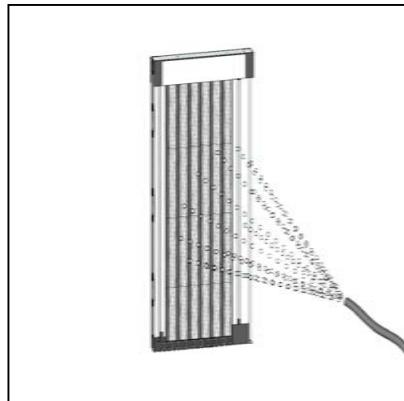
Om te reinigen zet u het pakket tegen een wand. Spuit water op het gaas en reinig het met behulp van een borstel. Let op dat daarbij de vouwlijnen van het gaas niet beschadigen.
