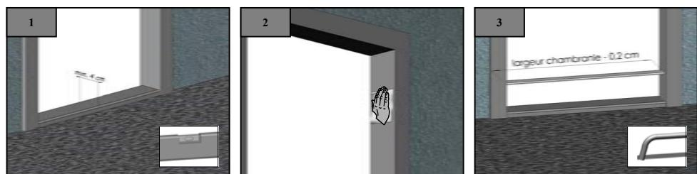
La porte-moustiquaire doit être placée sur un seuil plat. (Largeur min. 4 cm).
