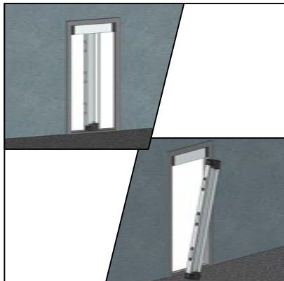
Open de deur en trek de bevestigingslijst met enige kracht los van de bevestigingsclips. Door het gaaspakket iets scheef te trekken, is de deur eenvoudig te verwijderen.
