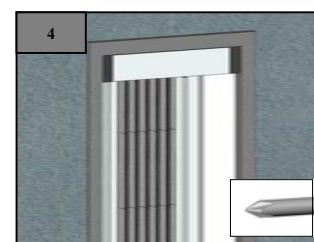
Positionieren Sie die Zugleiste vertikal und drehen Sie die Schraube wieder fest. Drücken Sie die Schutzplatte wieder auf die Zugleiste.
