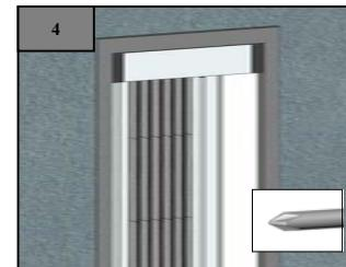
Plaats de treklijst verticaal en draai de schroef weer vast. Druk de afdekplaat terug op zijn plaats.
