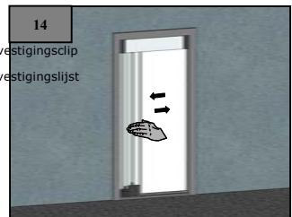
Druk de bevestigingslijst goed aan tegen de bevestigingsclips.
