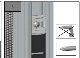
Lockern Sie die Schraube, die auf der Rückseite eine kleine weiße Platte hat, um ein paar Umdrehungen.
