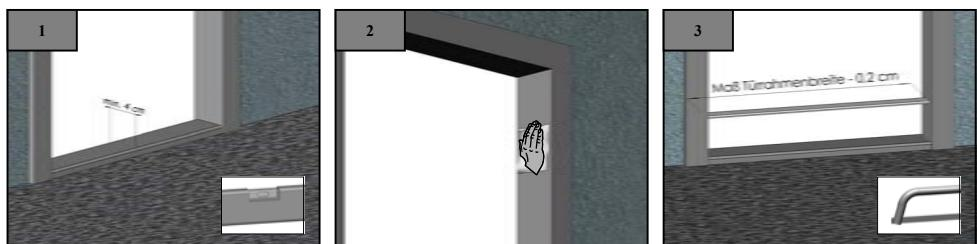
Die Plissé-Fliegengittertür muss auf eine flache Türschwelle montiert werden. (Breite min. 4 cm).
