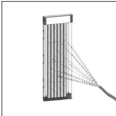
Zur Reinigung lehnen Sie den Gazerahmen gegen eine Wand. Spritzen Sie Wasser auf die Gaze und reinigen Sie sie mit einer Bürste. Achten Sie dabei darauf, dass die Falten der Gaze nicht beschädigt werden.
