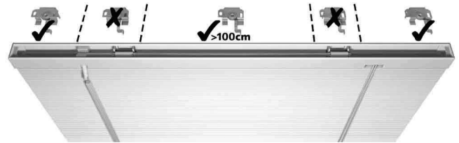
plaatsing van de montagebeugels op de bovenbak
